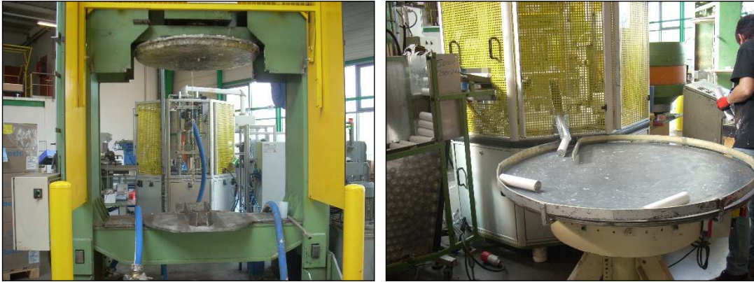
Figure I - 13 : Conditionneuses (porte-cuve à gauche et sortie des cartouches pleines à droite)
